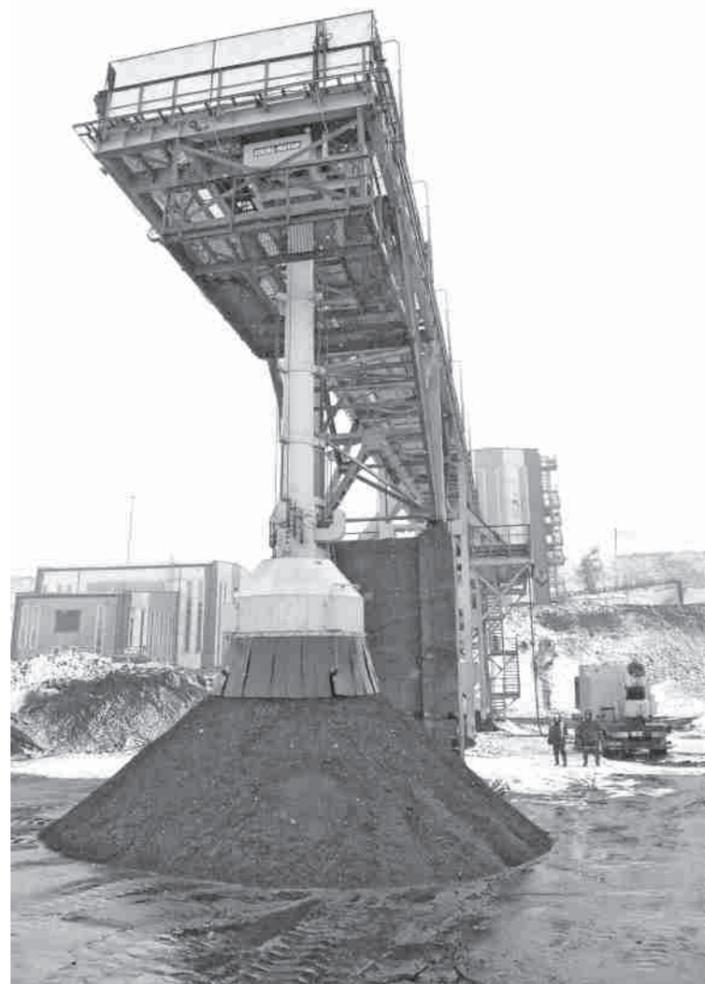
■ Установка телескопического разгрузчика на галерею отсева – еще одна мера пылеподавления. Фото Федора Баранова.
