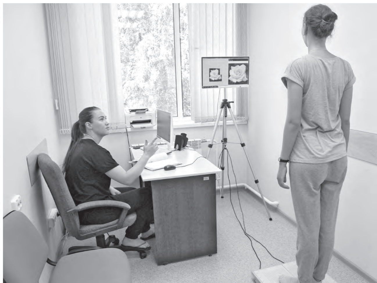
Платформа «Стабилон» работает на принципах биологической обратной связи: пациент собирает картинку на экране, контролируя перенос центра тяжести собственного тела. Фото Федора Баранова.
