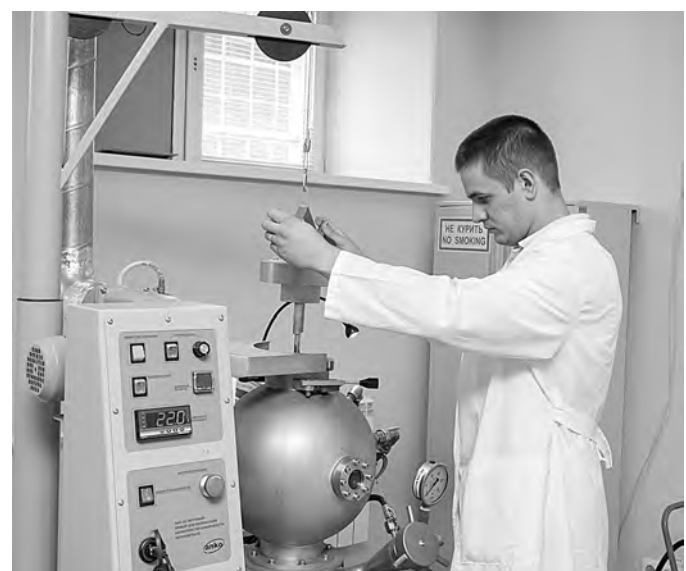
Сейчас на современном оборудовании можно определить характеристики взрывоопасности пылевоздушных смесей согласно европейским стандартам: EN 13821, EN 14034.
