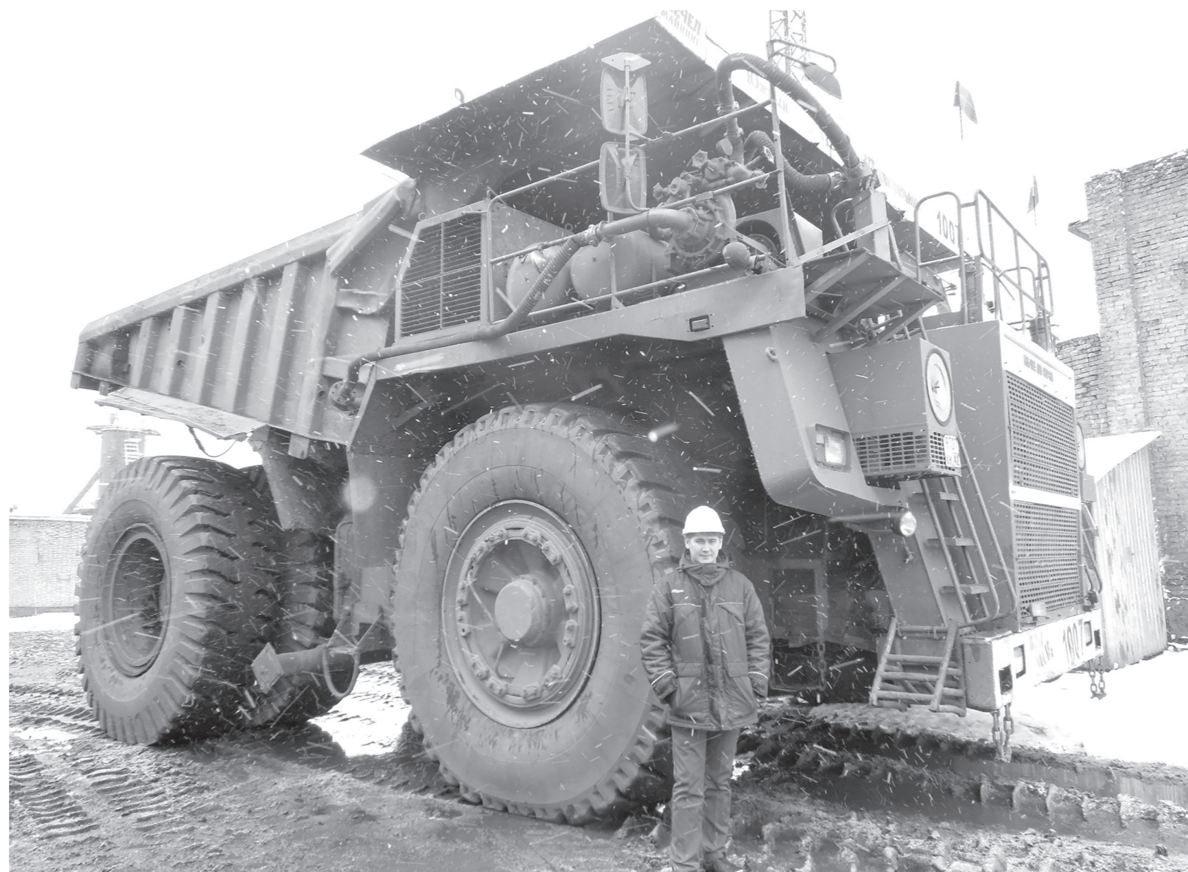
Вот он, пожарный «БелАЗ» с 60 тоннами воды на борту. Фото Ларисы Максименко.
