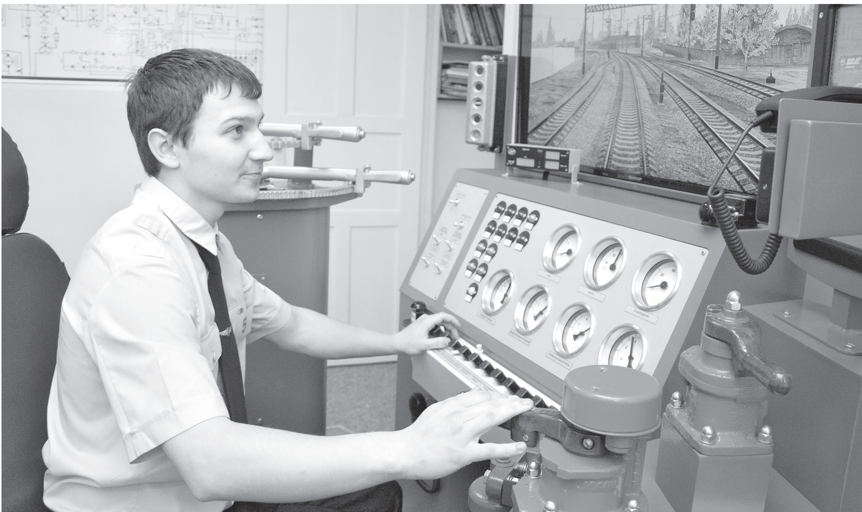
■ Студент Профессионального колледжа г. Новокузнецка Владимир Кузичев работает на современном тренажерном комплексе — полной имитации кабины электровоза. Такой комплекс используется при обучении машинистов локомотива. Фото Александра Павлова.
