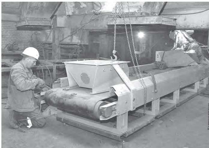
■ Установка весовых дозаторов поможет точнее дозировать сырьевые компоненты при подаче в мельницу.
