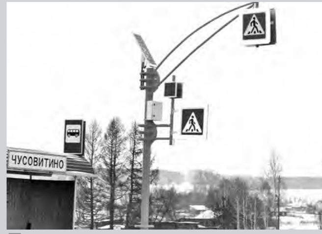
Так выглядит светофор с солнечной батареей. Фото Виктора Сохарева.
