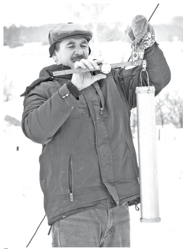
🔲 Агрометеоролог Юрий Кайгородов измеряет плотность снега специальным прибором (плотномером) и взвешивает его. По плотности снега судят о снегозапасах. Метеостанция в п. Новостройка (Кемерово).
