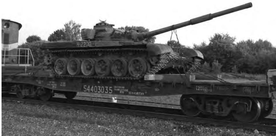
При перевозке по железной дороге грузовики, тракторы и даже танки заезжают на платформы по специальным переходным мосткам. Когда их нет – весь процесс погрузки может затянуться на неопределенно долгое время.
