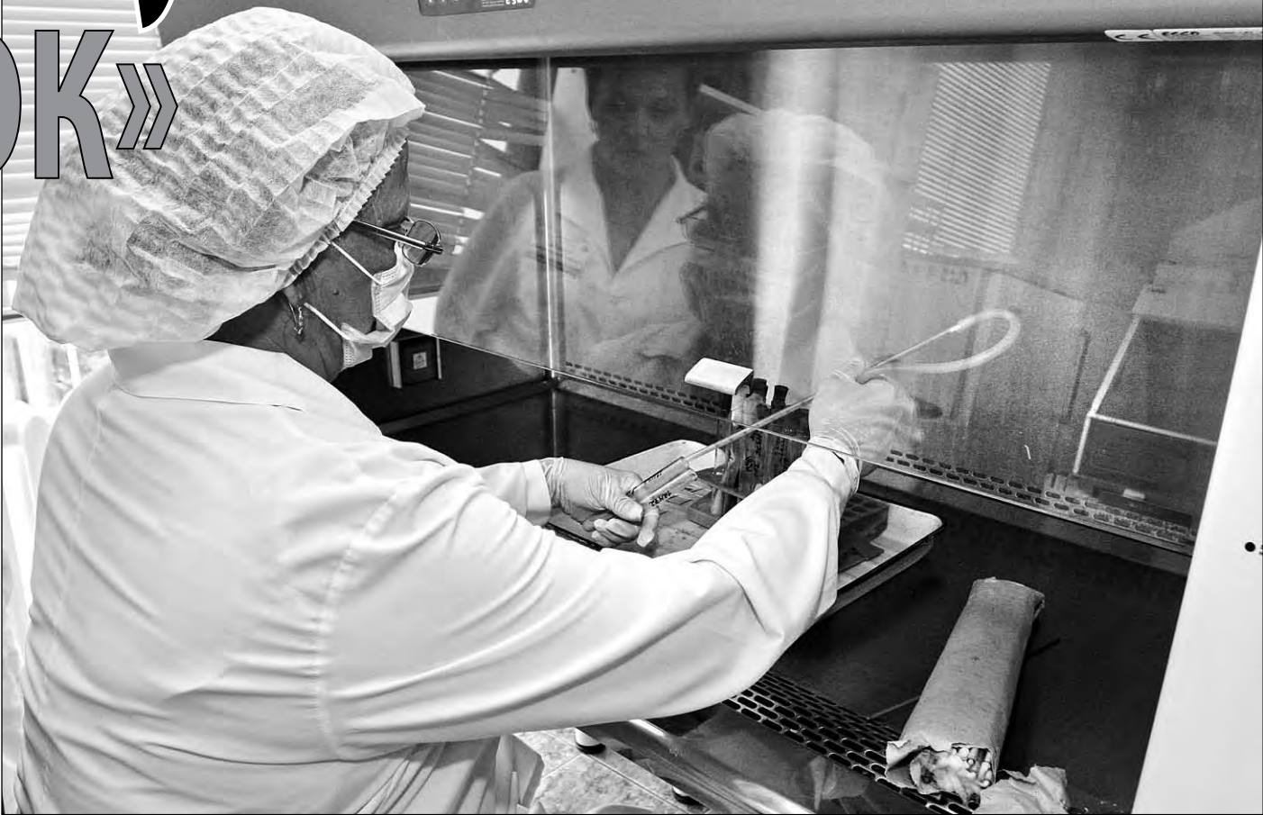
Шкаф безопасности позволяет «вывести» руки лаборанта в особую зону и уже там выполнять манипуляции с заразным биоматериалом. Фото Федора Баранова.
