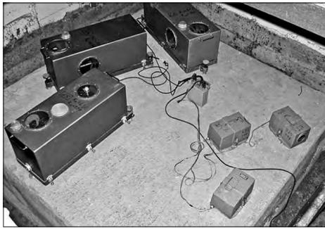
Оборудование на Кемеровской сейсмостанции круглоосуточно фиксирует малейшие колебания в земной коре.
