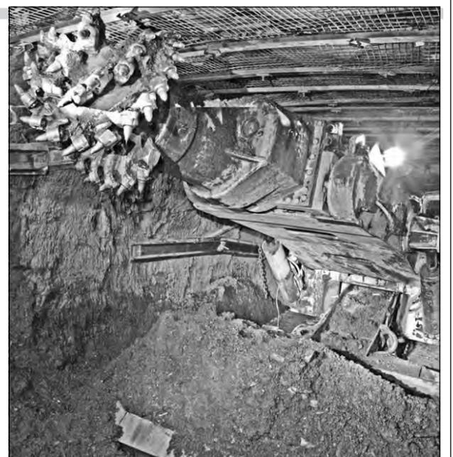
системе радиоуправления комбайном. Среднесуточное проходение штрека составило 12 метров, максимально достигнутое суточное проходение – 15 метров.
