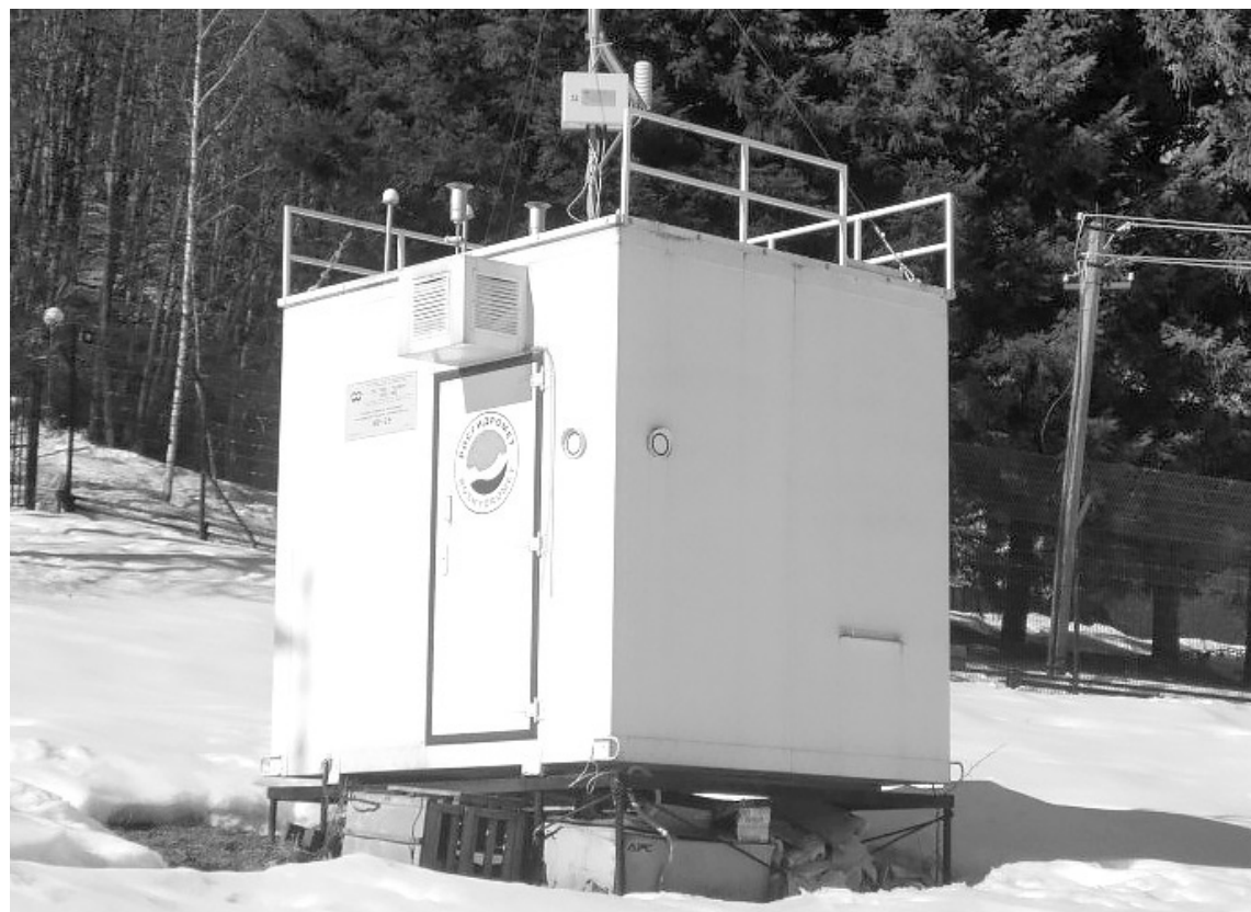
■ Автоматизированный пункт наблюдения за загрязнением атмосферы. Фото с сайта Росгидромета.
